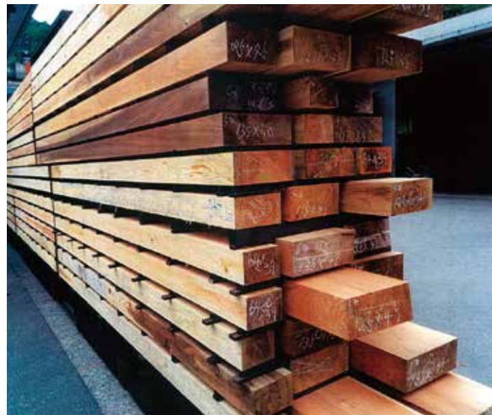
乾燥釜から出てきた状態。平角材、正角材、板材も一緒に乾燥されています。
