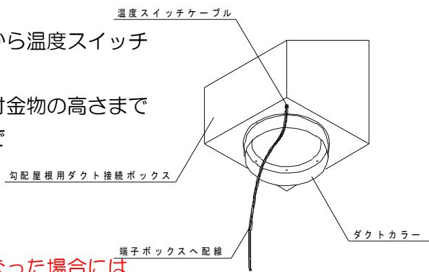
将来、温度スイッチの交換が必要になった場合にはダクトを取り外し、吊線を緩める事で温度スイッチが手元に降りてきますので、容易に交換が可能です。
