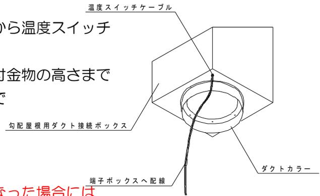
将来、温度スイッチの交換が必要になった場合にはダクトを取外し、吊線を緩める事で温度スイッチが手元に降りてきますので、容易に交換が可能です。
