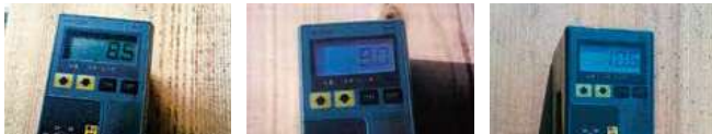
平角材の乾燥後の含水率 左から8.5%・9%・10.5% 材の芯部を水分計で測った含水率。
